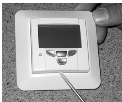
Demontering av frontplaten på et Premium-kontrollpanel.
